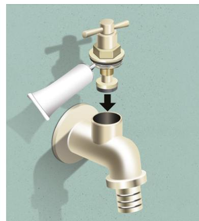
Se **decidi di sostituirla**, premila bene, metti un po' di grasso al silicone sulla parte del filetto e rimonta il vitone con la guarnizione nuova.
