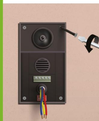
Rimetti la base in posizione contro il pilastro, fai ripassare i cavi e **avvita**.
