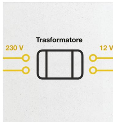
In funzione del modello, il cavo deve essere collegato direttamente nel punto in cui è fissato il trasformatore nel quadro modulare. Il trasformatore 230-12 Volt deve essere fissato su un binario DIN.
