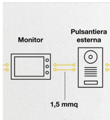
Da questo punto, il cavo a due fili da 1,5 mmq deve passare nel tubo corrugato fino alla posizione del monitor. Dal monitor devono ripartire due fili da 1,5 mmq che vanno **fino alla pulsantiera esterna**.
