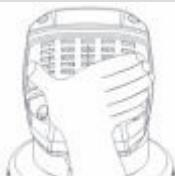
1. Scoateți din priză pistolul de vopsit. Îndepărtați capacul filtrului cu ajutorul unei scule (precum o șurubelnită plată).
