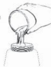
4. Ponownie napełnić pojemnik pistoletu **NOWYM** roztworem czyszczącym.
