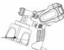
Prin îndreptarea tubului de aspirație în direcția corespunzătoare, nu va trebui să reumpleți rezervorul aşa de des.
