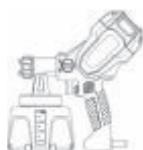
2. Deșurubați rezervorul. Goliți materialul rămas în rezervorul de material.
