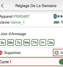
Appuyer sur « Ajouter » pour déterminer un cycle d'arrosage (jusqu'à 12 cycles maximum).
