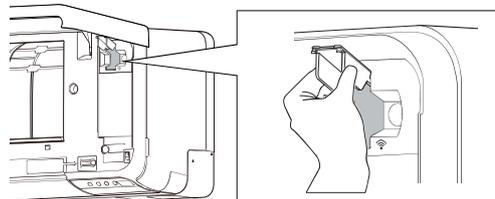
4. Rimuovere l'adattatore WLAN dallo slot di collegamento dell'unità interna nella direzione indicata nella figura.
