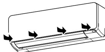
**NOTA:** Se si accumula polvere sul filtro dell'aria, il flusso di aria risulterà ridotto, l'efficienza di funzionamento diminuirà e aumenterà il rumore.
