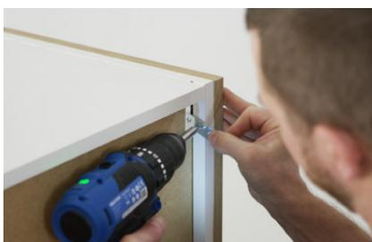
► **Mettre en place les platines** à la place des équerres, puis joignez, ajustez.
