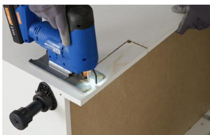
► **Percez aux deux coins intérieurs** du tracé avec une mèche de 10 à 12 mm, pour permettre les découpes à la scie sauteuse. Répétez l'opération pour l'autre côté.
