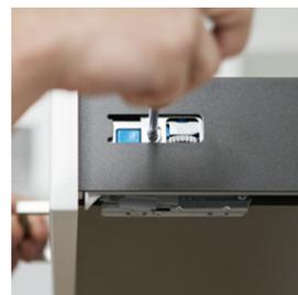
▶ **Grâce à la vis** pour la largeur, contrôler à nouveau.
