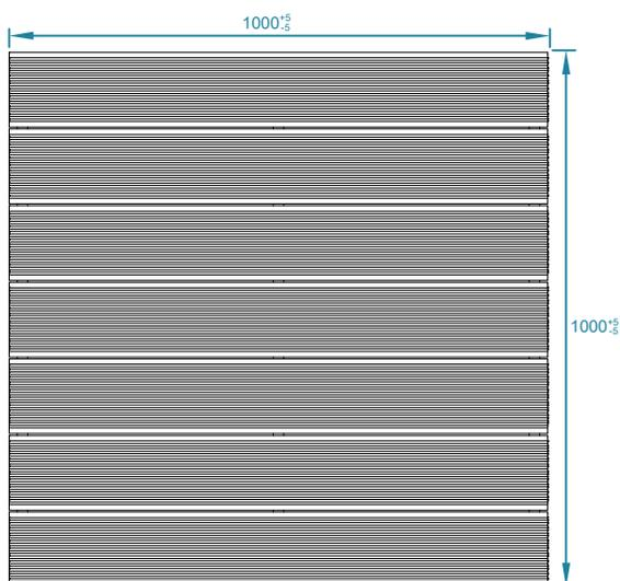
Nota: la tolerancia de todas las dimensiones de todos los componentes individualmente o en relación a los demás es de  $\pm 5$ mm.
