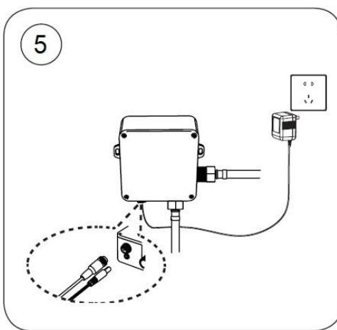
Conecte el sensor IR a la caja de control, alimentar el sistema a través de la toma del transformador.
