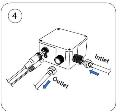
Instale los elementos y conecte las entradas de agua (IN/OUT).
