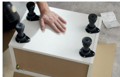
► **Se i mobili sono collocati con un lato a vista,** è necessario posizionare la parte triangolare dei piedi verso l'interno per lasciare lo spazio necessario allo zoccolino. Se questa non è la vostra configurazione, potete posizionare la parte triangolare verso l'esterno per rendere il mobile più rigido.
