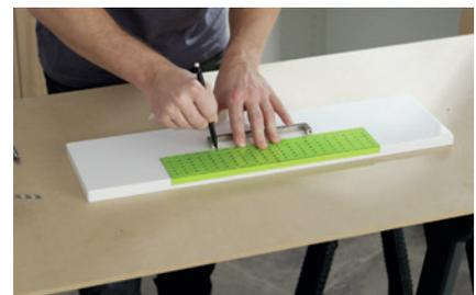
► **Fare poi riferimento** alle istruzioni per determinare la parte superiore e inferiore del frontale del cassetto, individuare il centro del frontale. Utilizzate la dima per segnare l'interasse della maniglia.
