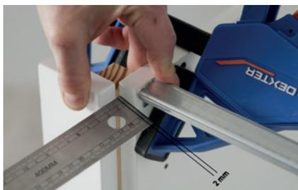
► **Posizionare la fascia** di tamponamento sul mobile con una distanza di 2 mm verso la parte anteriore.
