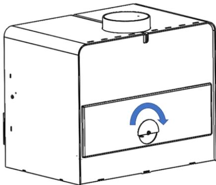
Figura n°8 - Registro de entrada aire doble combustión abierto
