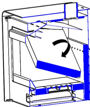
Figura nº11 - Extracción de los deflectores de vermiculita
