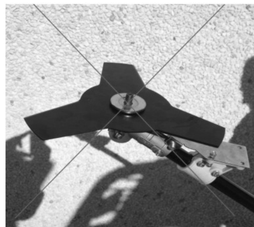
Arandela de apoyo de forma incorrecta!
