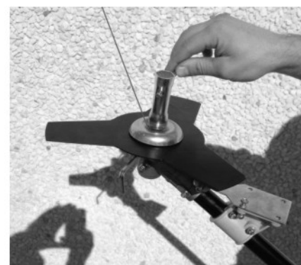
Porca de aperto para a esquerda (sentido contrário aos ponteiros do relógio)
