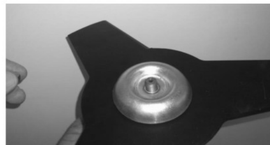
Taça metálica de proteção colocada.
