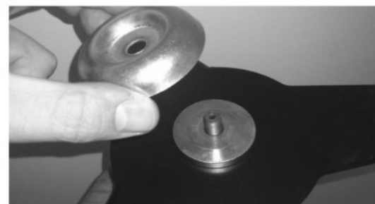
Colocación de la taza de protección.
