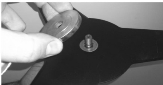
Colocação da anilha de fixação exterior com a parte oca virada para o disco.
