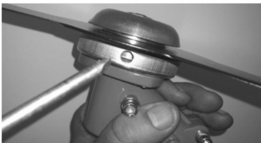
Colocación de la llave L en el agujero lateral de la cabeza para coger el eje de soporte del disco.
