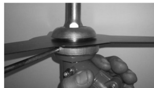
Com a chave L introduzida, coloca-se a chave de aperto da porca de fixar o disco, e roda-se esta chave em sentido contrário aos ponteiros do relógio, desta forma aperta-se o disco.
