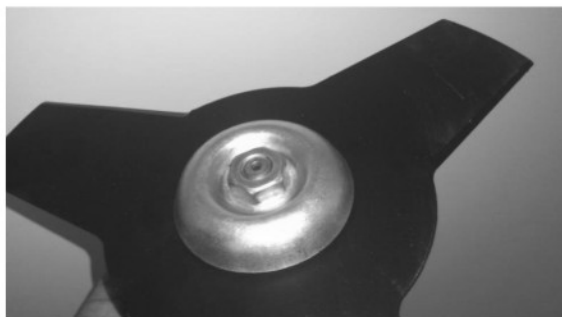
Porca de aperto do disco colocada.
