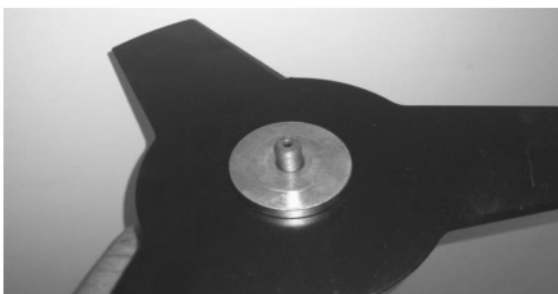
Anilha de fixação exterior do disco colocada de forma a fixar o disco.
