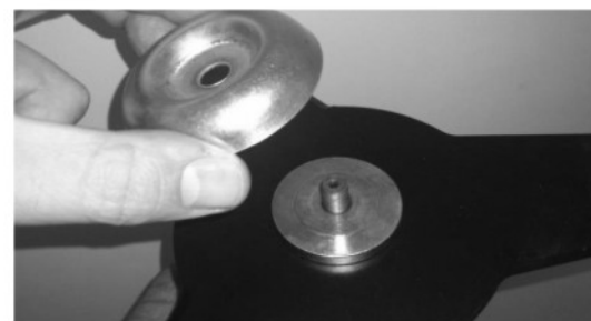
Colocação da taça metálica de proteção.
