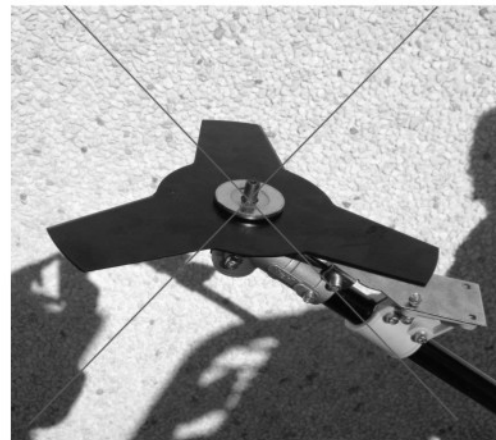
Anilha de fixação exterior do disco colocada de forma incorreta.
