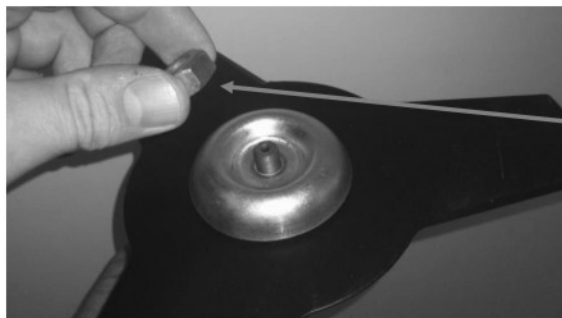
Colocação da porca de aperto do disco.
