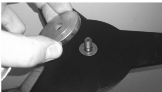
Colocación del arandela de fijación exterior con la parte oca hacia el disco.
