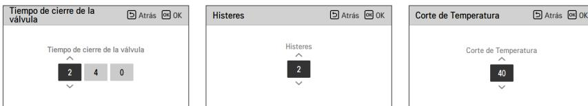
Función de ajuste del instalador para ajustar el funcionamiento de la bomba de agua y la opción del tiempo de retardo en el modo de calefacción
