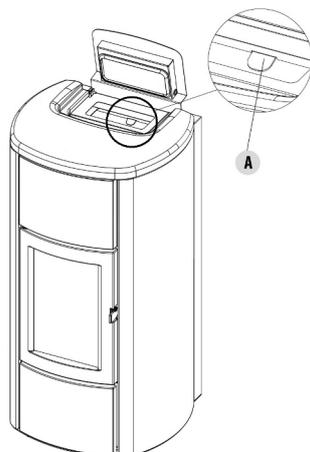
**Fig. 20 - Palanca para la limpieza de los dispositivos de turbulencia (Idro Prince<sup>3</sup> 16-23-23 H2O, Aquos<sup>3</sup> 16-23-23 H2O, Idron 16-22 Airtight, Hidrofire 22.8)**
