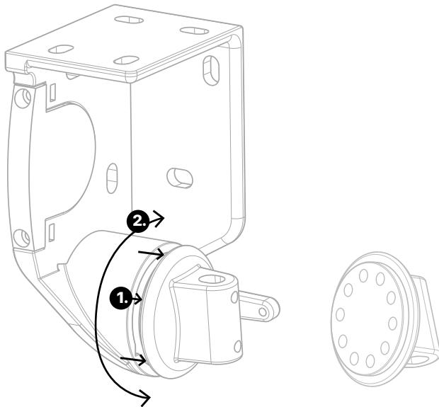
2. Esta peça deve ser deslocada em função da inclinação que se pretende obter. Deve encaixar a peça em dois dos orifícios propostos, consoante pretenda um maior ou menor grau de inclinação. Uma vez selecionada a posição, apertar novamente a porca hexagonal para fixar o conjunto.
