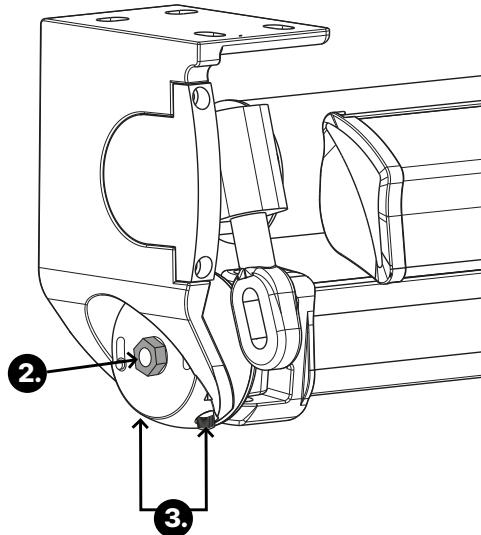
3. Gira la llave allen actuando sobre los dos espárragos interiores con una llave allen nº5, gira poco a poco sobre uno u otro, comprobando el sentido de giro para ajustar el brazo hasta la posición deseada. Una vez seleccionada la posición, aprieta el tornillo del paso 2 y coloca las tapas plásticas.
