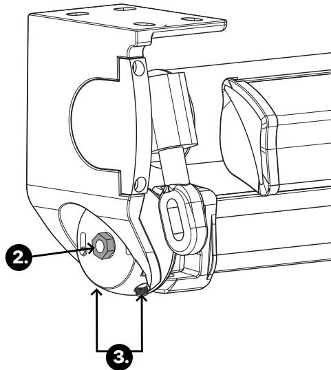
3. Tourner la clé allen en agissant sur les deux goujons intérieurs avec une clé allen n°5, tourner l'un ou l'autre petit à petit, en vérifiant le sens de rotation pour ajuster le bras à la position souhaitée. Une fois la position choisie, serrer la vis de l'étape 2 et monter les couvercles en plastique.
