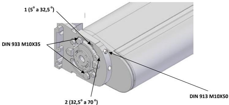
[ES] Para la regulación de la inclinación del conjunto de 5 a 32,5° utilizaremos la posición 1 del espárrago roscado y de la tuerca cuadrada, y para regular entre 32,5 y 70 la posición 2 (Ambas indicadas en la imagen).
