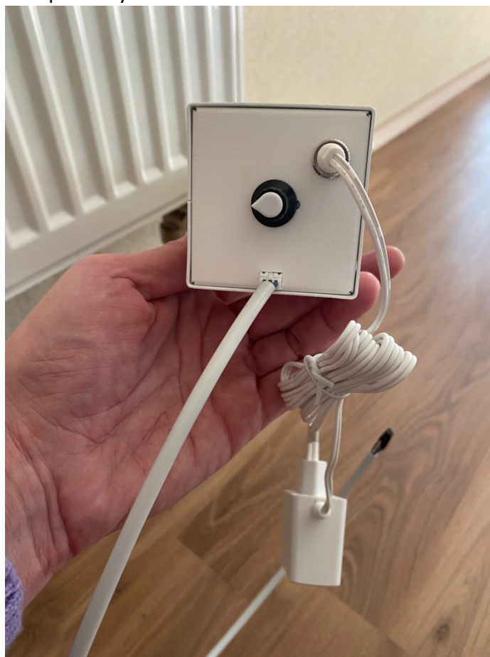
Rys. 2 Podłączenie adaptera i czujnika temperatury
