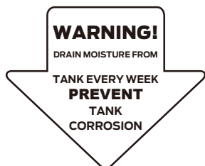
Etiqueta de advertencia sobre drenaje: drene la humedad del depósito semanalmente para evitar la corrosión del mismo.
