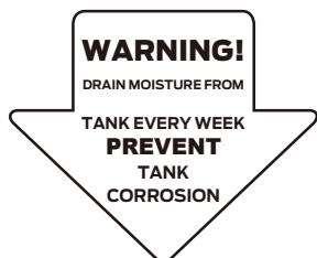
Etiqueta de aviso de drenagem: Drene a humidade do depósito todas as semanas, para evitar a corrosão do depósito.
