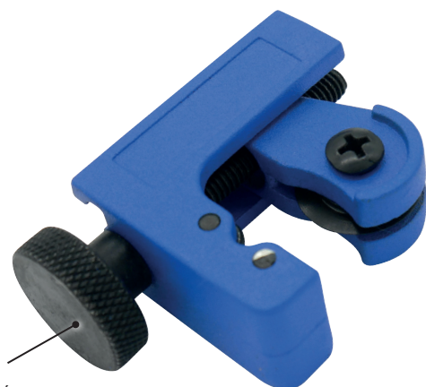
MOLETTE DE RÉGLAGE DU DIAMÈTRE DE COUPE (3 À 22 MM)
