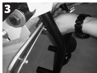
Tuercas y pernos largos (M8x35) para la parte delantera
