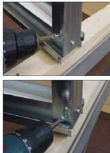
PHASE 2: JOINDRE LES TROUS DES DEUX ÉLÉMENTS ET LES UNIR EN UTILISANT LES VIS EN DOTATION À L'AIDE D'UNE VISSSEUSE ÉLECTRIQUE.
