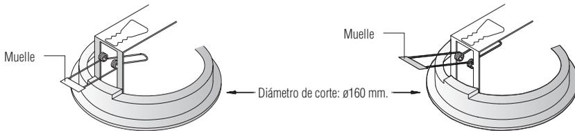
Fijar los muelles en el soporte metálico con el ángulo hacia abajo para techos o tabiques delgados de 5 a 35 mm. de espesor.
