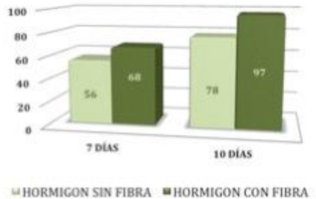
ROTURA POR COMPRESION EN PROBETAS DE HORMIGON
