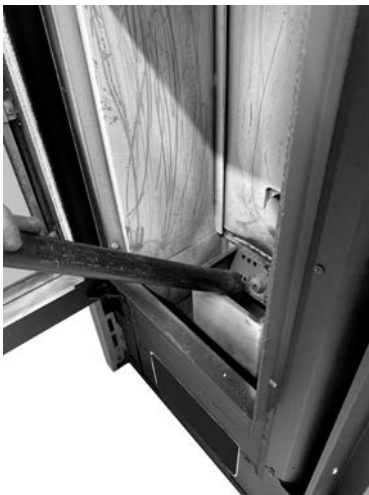
Fig. 29 - Limpieza alojamiento brasero
