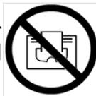
El aparato de calefacción no debe colocarse inmediatamente debajo de una base de toma de corriente.
