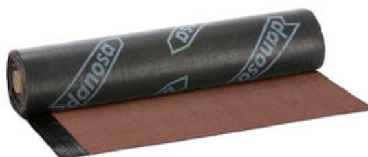
Lámina bituminosa de superficie autoprottegida tipo LBM(SBS)-40/G-FP R. Está compuesta por una armadura de fieltro de poliéster reforzado, recubierta por ambas caras con un mástico de betún modificado con elastómeros (SBS), acabada en su cara externa en gránulos de pizarra, como material de protección. En su cara interna, como material antiadherente, incorpora un film plástico de terminación.
