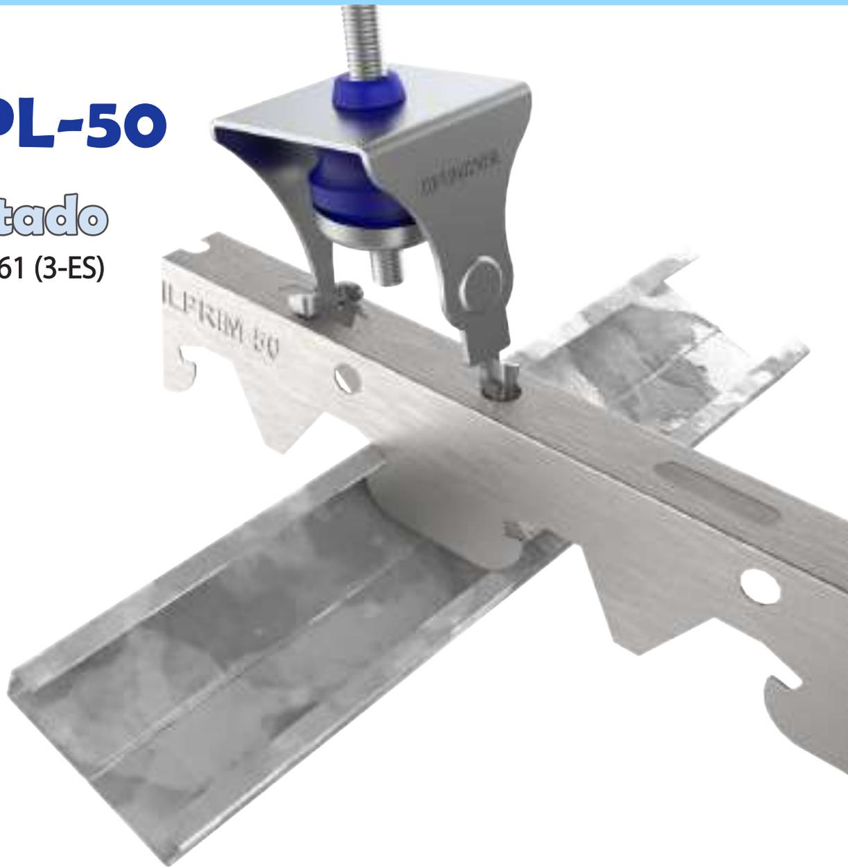
(B) Carcasa exterior de acero galvanizado, fabricada en acero galvanizado de alto rendimiento **Dx54d + Z140** con un espesor de canto de 1,5 milímetros. Aporta la rigidez del sistema y la inserción rápida al perfil de techo.
