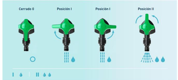
Dos tipos de servicio: posición I (menor caudal) y posición II (mayor caudal). Mando de apertura reversible: abre tanto a derecha como a izquierda en la posición I. Diseño ergonómico del mando que aporta mayor dureza de maniobra y un sonido (sistema click click!!) que indica el correcto posicionado del mando.
