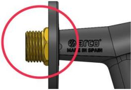
El grifo dispone de un inserto fabricado en latón CW614N en la conexión de entrada. Asegura máxima resistencia al conectarse a cualquier tipo de accesorio y usar cualquier sellante.
