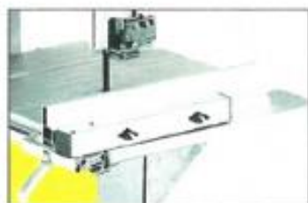
Tilting table up to 45°, goniometer included Mesa de trabajo inclinable hasta 45°, goniómetro incluido
