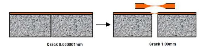
La fuerza resultante de la aparición de fisuras se absorbe en el Sikalastic®-612. Debido a la menor resistencia a tracción del Sikalastic-612 en comparación con la adhesión y la resistencia del soporte, toda la fuerza la soportará el revestimiento y su elongación pura. La poca distancia (0,001 mm) a cubrir, provoca una variación en elongación a soportar infinita y, por ello, se acaba calcando la fisura desde el soporte.
