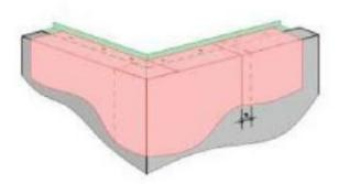
3. Aplique la segunda capa del Sikalastic®-612 sobre el Sikalastic® Fleece 120. Retire la cinta de enmascarar antes de que se seque el Sikalastic®-612. Así estará terminado el detalle. Deje que se seque antes de comenzar con la aplicación del Sikalastic®-612 sobre toda la superficie de la cubierta, tal y como se describe en la página 12.
