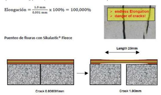
En comparación con la aplicación sin reforzar, la resistencia a tracción es mayor que la necesaria para despegar el sistema de la superficie en la fisura- comenzando con un ancho mayor, la elongación necesaria es menor y el sistema tiene mayor capacidad de resistir la fisuración del soporte.
