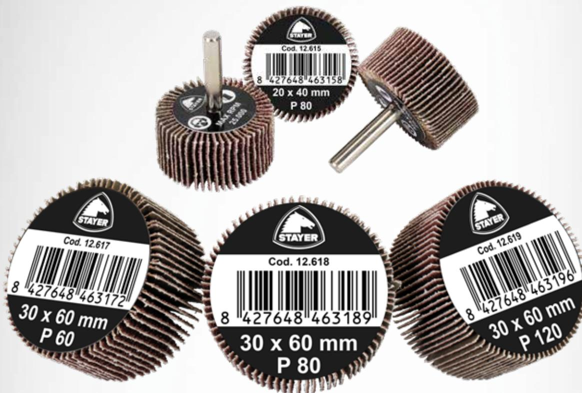
Abanicos de láminas abrasivas fabricadas con corindón de alto rendimiento, gran flexibilidad para adaptarse al lijado de cualquier tipo de contorno. Accesorio para pulido y desbaste de cordones de soldadura y rebabas de corte, perfiles de metal y tubos. Para inox, aluminio, madera, plásticos y piedra de dureza y abrasividad medias. Cada abanico cuenta con 80 láminas y un vástago de ø6 mm. Disponible en 2 tamaños y 3 tipos de grano.
