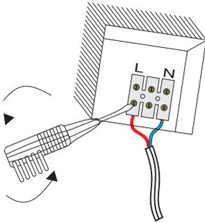
Antes de colgar el espejo, se procederá a destornillar el cajetín situado en el cable del espejo. En este, se enganchará cada uno de los cables procedentes del punto de luz de la pared.
