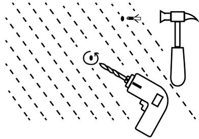
Taladre los puntos marcados y coloque los tacos en la pared. A continuación coloque los enganches donde se colgará el espejo. Según el modelo de espejo, se introducirán en los tacos tornillos o ganchos. Para asegurarse de que está bien nivelado, comprobar de nuevo con el nivel.
