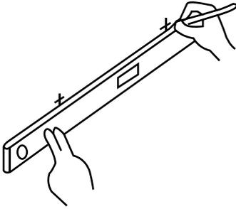
Mida las distintas distancias correspondientes a la altura respecto al lavabo y de los tornillos a sujetar el espejo. Mediante un nivel, marque donde serán necesarios disponer los enganches del espejo.
