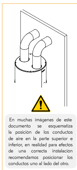
Fig. 1 Ejemplo de conexión de descarga de aire.
