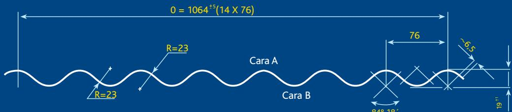
FABRICACIÓN EN ANCHOS "O" DE 836 mm. (11 x 76), DE 1.064 mm. (14 x 76), DE 1.292 mm. (17 x 76)
