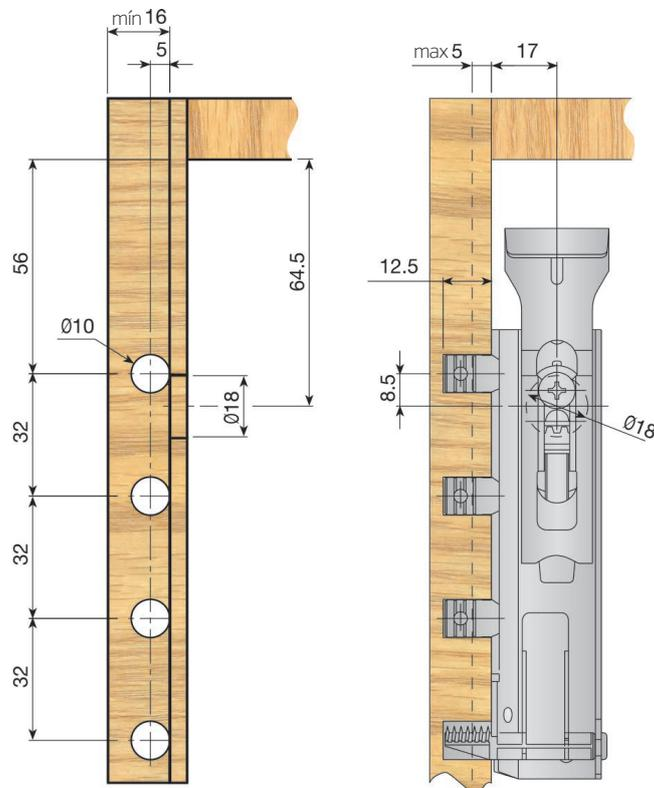
\* Para obtener una carga nominal de 65kg se debe atornillar un tirafondo de Ø3.5x20 en el agujero de fijación indicado.
