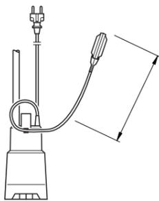
El punto de paro y arranque de la bomba puede reajustarse alargando el interruptor de flotador en su dispositivo de graduación.
