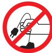
**Deberá sujetar la bomba por la agarradera prevista. Nunca debe instalar su bomba de manera que cuelgue libremente de la tubería a presión o del cable de corriente y colocarla en el fondo del sótano, etc.**
