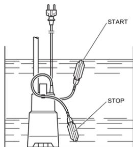
Al levantar el flotador la bomba se pondrá en marcha y al bajarlo, dejará de funcionar.
