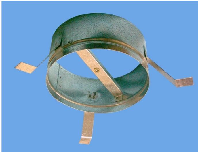
El cuello CF está fabricado en chapa de acero galvanizado y permite la instalación de difusores de cono fijo SERIE DR10 conectándolos directamente al conducto, sin necesidad de plenum.
