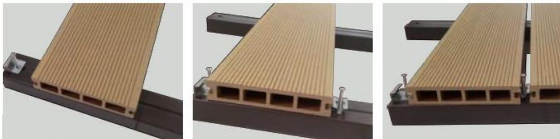
Uso de clips de acero inoxidable de la serie GG: coloque los clips GG en la ranura lateral de la lama y fíjela con tornillos, y luego empuje otra lama hacia adentro.
