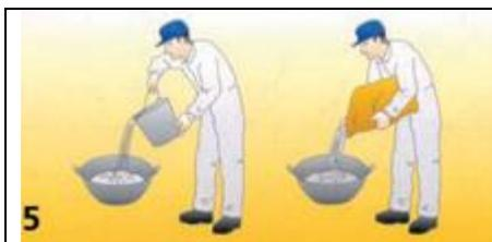
Se amasará a saturación, colocando el agua en la artesa y espolvoreando escayola lentamente para que no se formen grumos, hasta que la escayola quede enrasada con el agua, procediendo primero a su amasado y después, a batir la masa.
