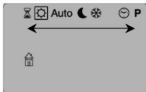
Desplácese con la tecla (►) y seleccione los distintos modos de funcionamiento “**Auto**”, encuadrando el deseado y pulse (OK).
