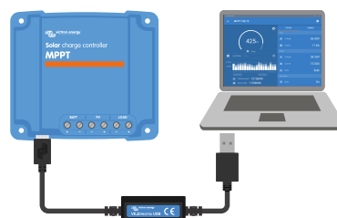
Conexión de la aplicación VictronConnect por USB con la interfaz VE.Direct USB
