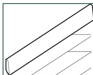
Instale los rodapiés con la cola One4All de Vibrance by Pergo en la pared. Si elige rodapiés o Scotia a juego, use las Hydrostrips correspondientes para evitar la entrada de agua y para conseguir un aspecto limpio y acabado. Los rodapiés listos para pintar y resistentes al agua (NEVSKRPAINTA) se pueden usar sin Hydrostrip.
