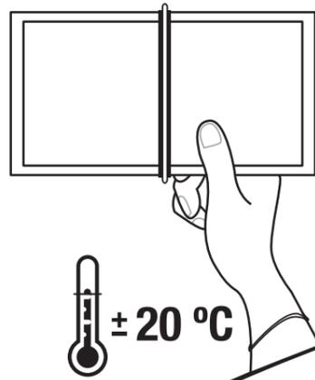
**ES** Mezclar la resina, rellenar el molde hasta 3mm por debajo del orificio superior y tapar.
