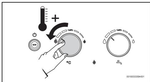
Fig. 7 Incrementar potencia
