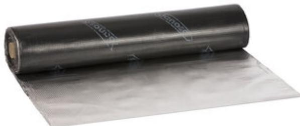
Es una lámina impermeabilizante bituminosa autoprottegida, tipo LBM-30/M-NA (APP -5 °C). Está compuesta por un mástico de betún modificado con plastómeros (plegabilidad -5°C). Como material de protección, en la cara externa se usa una hoja de aluminio gofrado de color natural. Como material antiadherente en su cara interna, se usa un film plástico de terminación.
