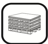
El paletizado o apilado del producto debe realizarse sin rozar las piezas entre sí y evitando el atrapamiento de partículas de cualquier tipo entre las mismas.
