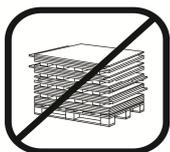
Los soportes entre los diferentes paquetes deben quedar bien alineados para una buena distribución del peso, evitando así deformaciones en el material.
