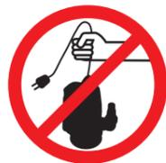
Nunca debe instalar su bomba de manera que cuelgue libremente de la tubería a presión o del cable de corriente. Deberá sujetarla bomba por el cable provisto para tal efecto.
