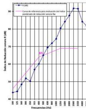
Índices según UNE-EN ISO 717-1:2013:  $R_w (C;C_2)$ : 65 (-2; -7) dB
