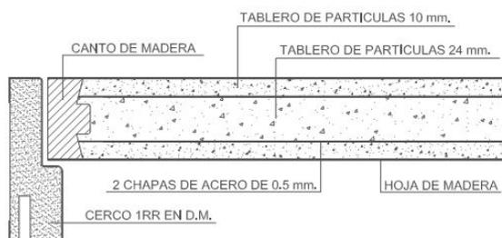
**Cerco:** extensible a un lado, fabricado sobre un tablero de fibras (d.m.) de 28 mm de espesor y recubierto de chapa natural de la misma especie que la utilizada en la puerta. Finalmente se aplica un barniz ultravioleta.
