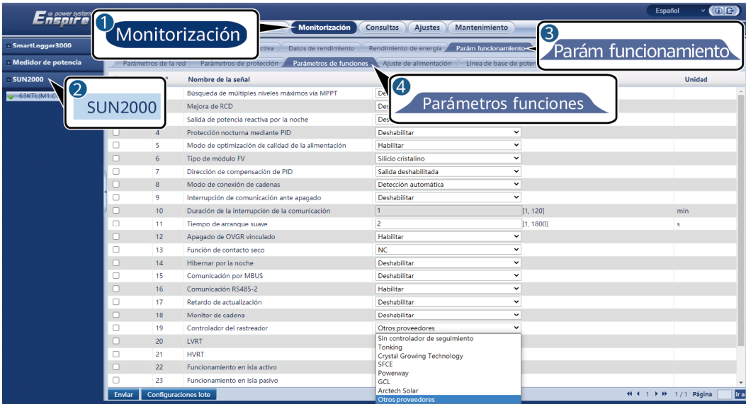
Figura 6-22 Configuración del controlador del sistema de seguimiento
