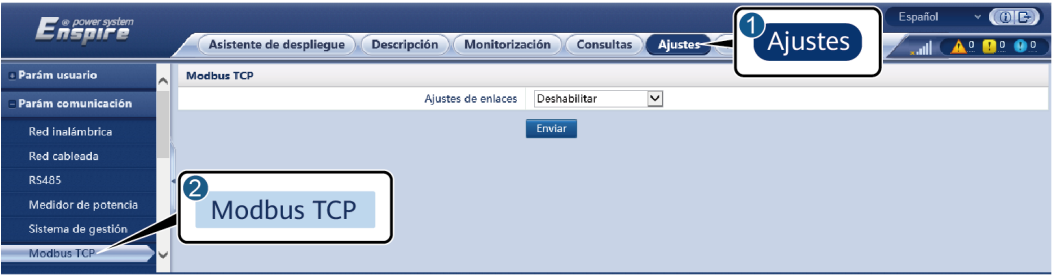
Figura 6-11 Configuración de los parámetros de Modbus TCP
