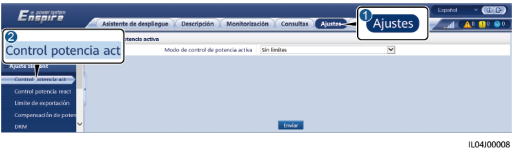
Figura 6-48 Control de potencia activa
