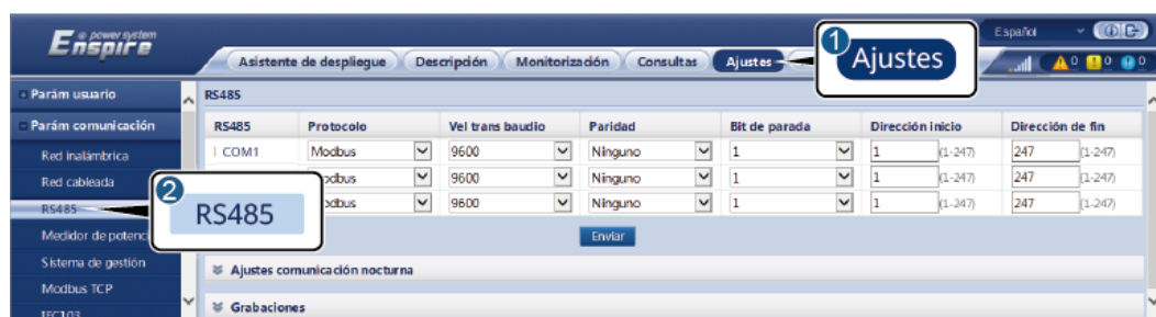
Figura 6-13 Configuración de los parámetros de RS485
