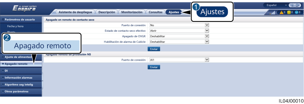
Figura 6-62 Apagado remoto de protección NS
