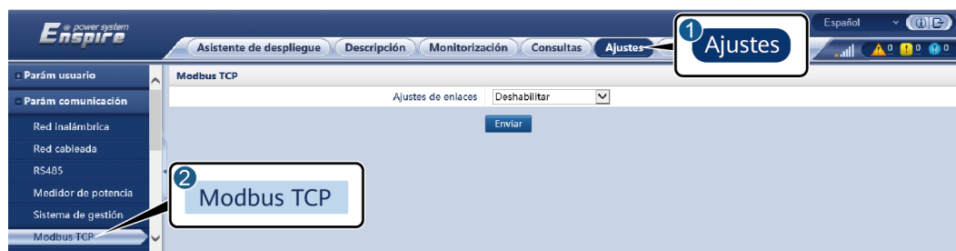
Figura 6-14 Configuración de los parámetros de Modbus TCP
