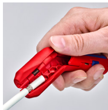
Retirar el aislamiento de un cable coaxial
